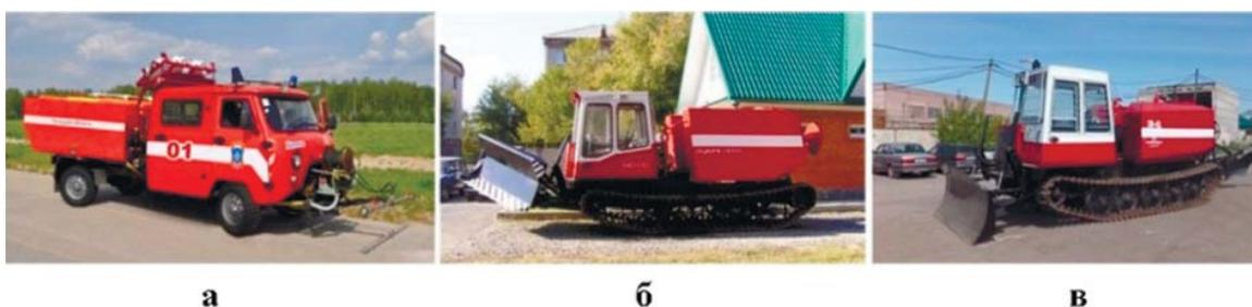
Рисунок 5 – Пожарная машина («Катюша») марки «МПМ-1500» (а), лесопожарный трактор МСН-10 ПМ «Рубеж 4000» (б), агрегат лесопожарный ТЛ-41 (в)
