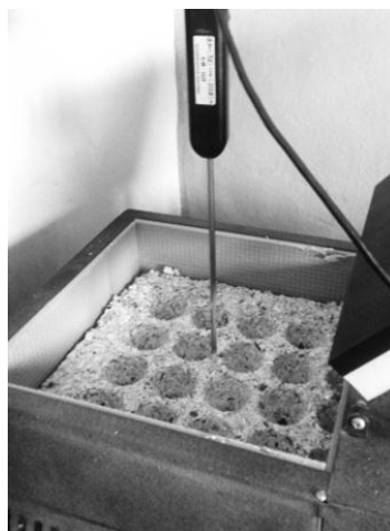
Рис. 3. Эксперимент по определению коэффициента теплопроводности плиты
