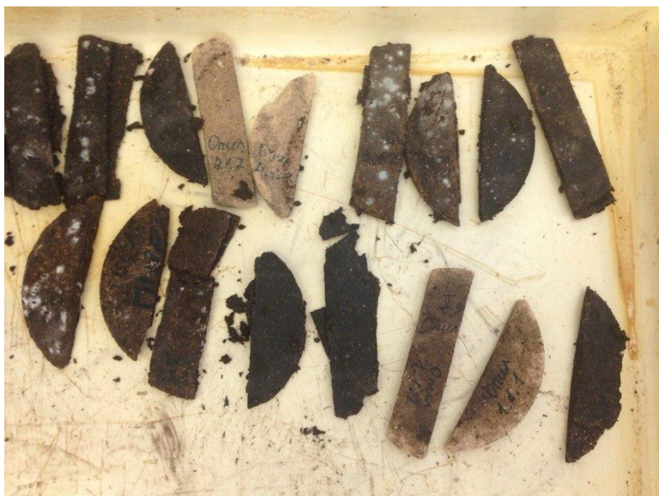
Рис. 1. Внешний вид образцов после испытаний на биостойкость
